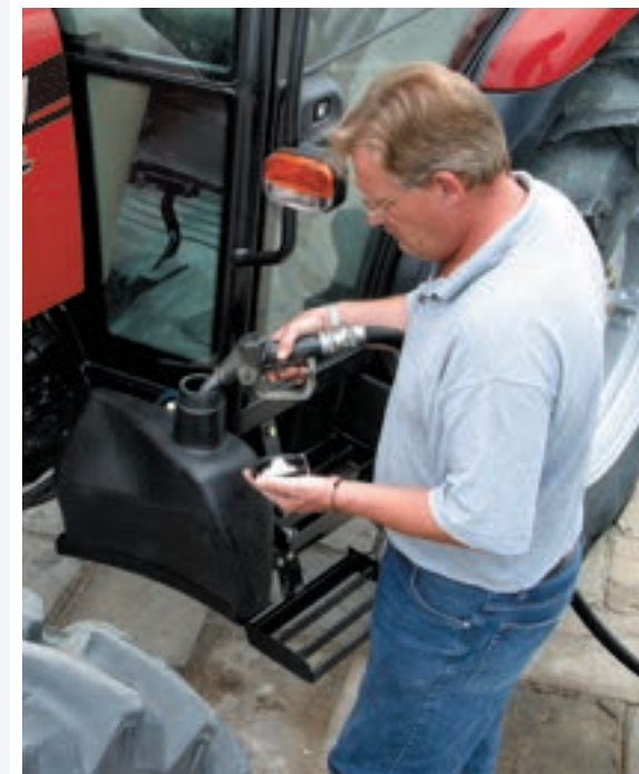
Reabastecimento a partir do solo, com o bocal de abastecimento facilmente acessível.
