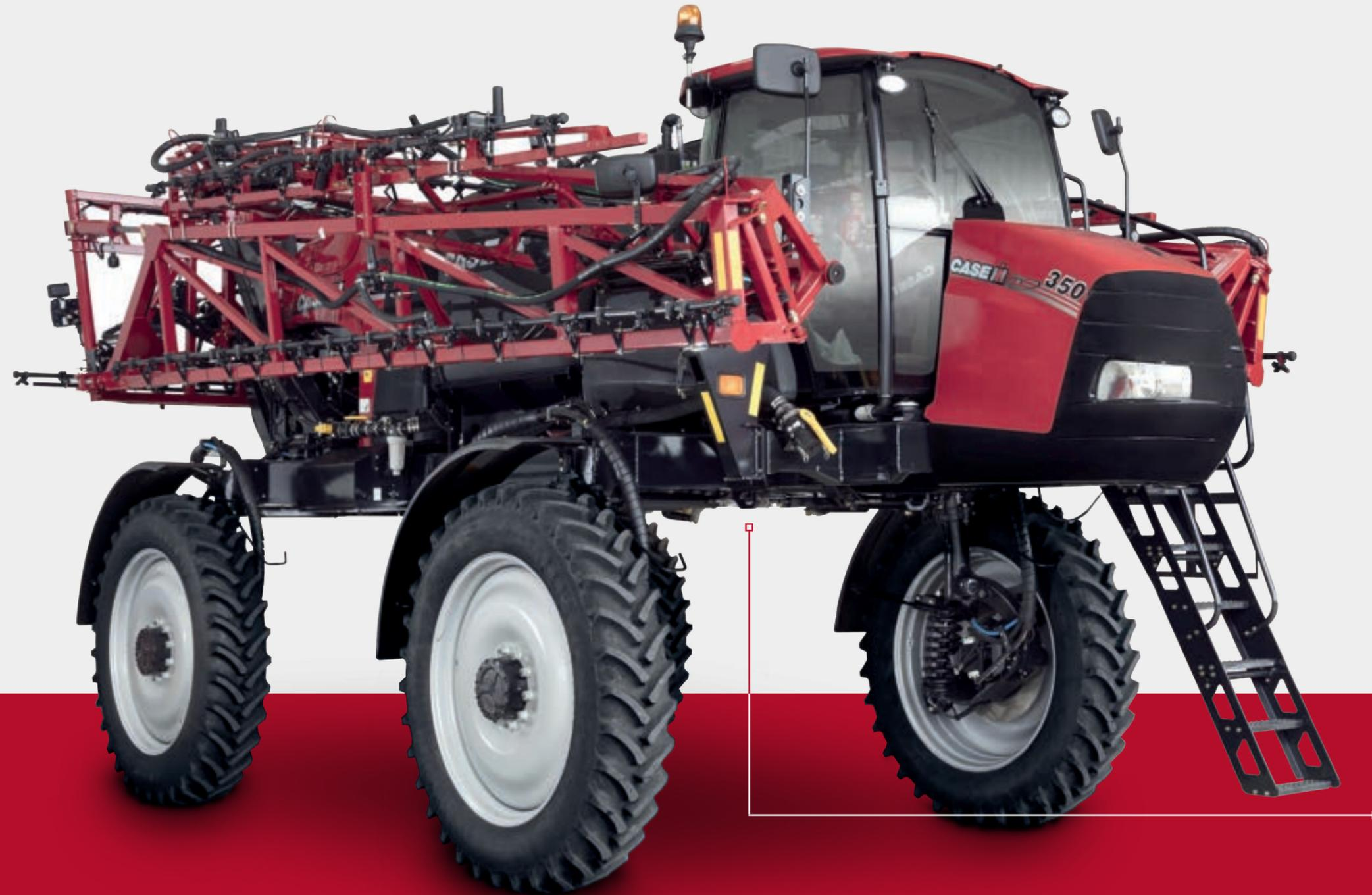
O seu motor Case IH FPT NEF de 250 cv, 6 litros, localizado na parte traseira, a cabine na parte frontal e o tanque de produto centralizado proporcionam uma ótima distribuição de peso e uma excelente estabilidade, além de acarretar uma menor compactação do solo.
